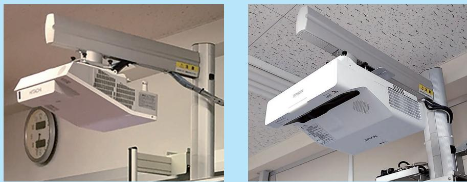
板面上部に可動式プロジェクターを設置すると、画像の位置を自由に選べます。
